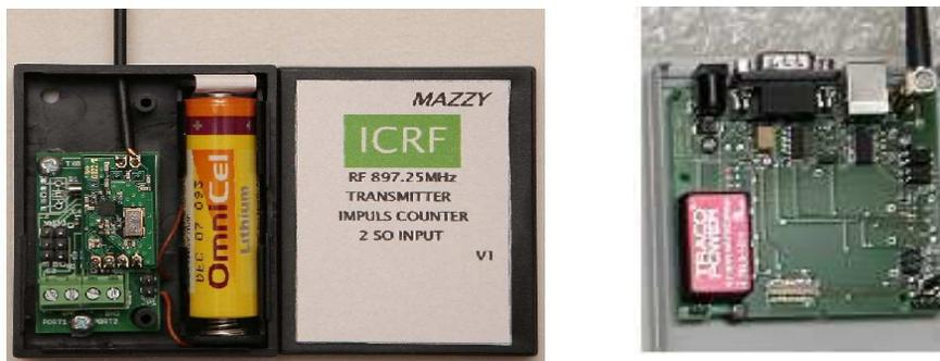
Рис. 10. Средства радиосбора показаний счетчиков: а) квартирный передатчик, б) домовый передатчик со встроенным модемом GSM/GPRS.
