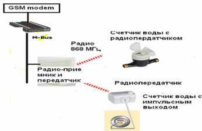
Рис. 9.Схема сбора показаний счетчиков по радио (на частоте 868 МГц)
