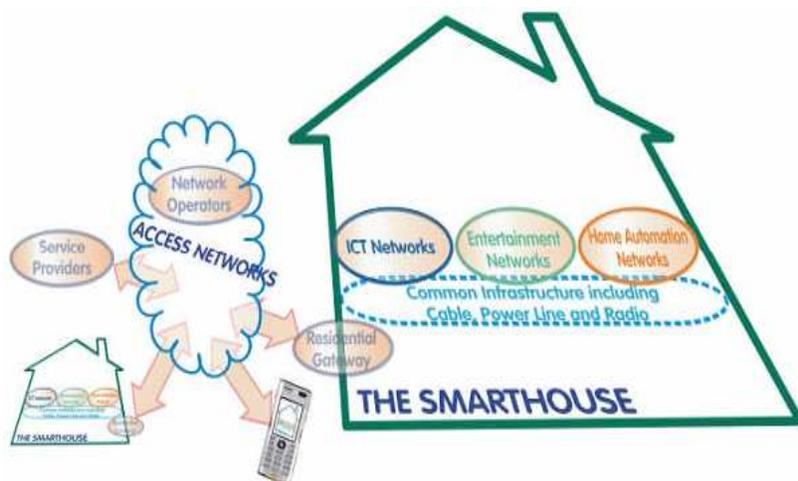
Рис. 3. Упрощенная архитектура SmartHouse: сети внутри и вне дома
