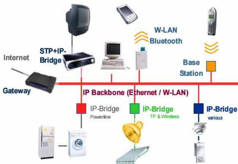
Рис. 1. Пример домашней сети на базе Интернета
