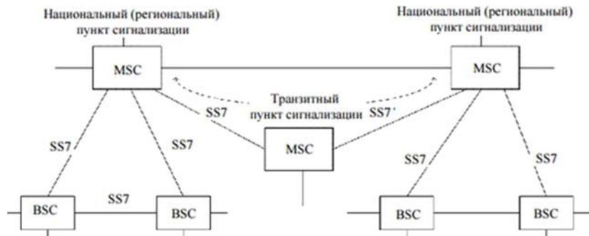
Рис. 9. Упрощенная схема сети SS7 в системе GSM-R
