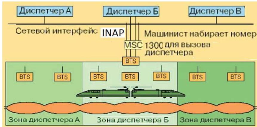
Рис. 13. Адресация в зависимости от местоположения [9]
