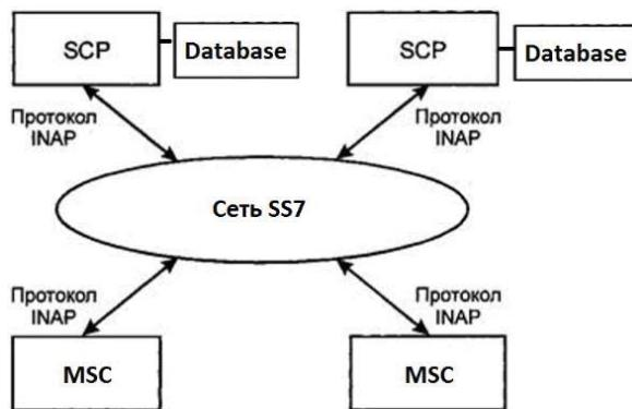
Рис. 11. Использование протокола INAP в интеллектуальной сети
