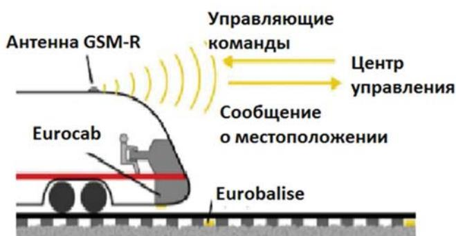
Рис. 1. Схема действия ERTMS
